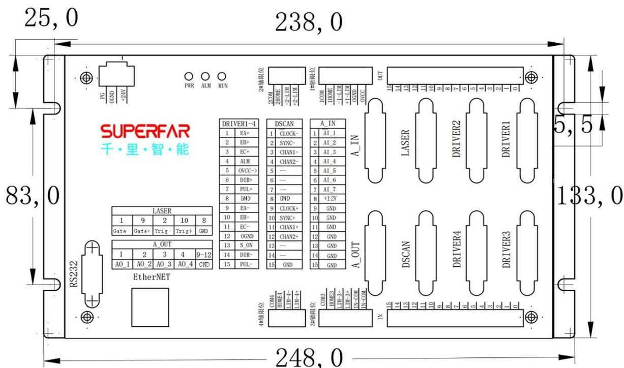
QLS-4213DPRT 控制卡是千里智能自主研发的高端平台振镜联动卡,采用强大的 CPU 计算,主要用于有多轴运动的平台、振镜、激光的加工应用中,实现平台振镜联动,大大提高加工效率,如 3D 打印, PCB/FPC,指纹识别芯片,摄像头模组等激光精密切割,大幅 PCB 打标,晶圆打标等。
