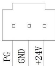
电源 24V 电流不小于 1A，请注意方向和顺序！**建议：单独使用一个 24V 电源，保证板卡供电与输入输出隔离。**
