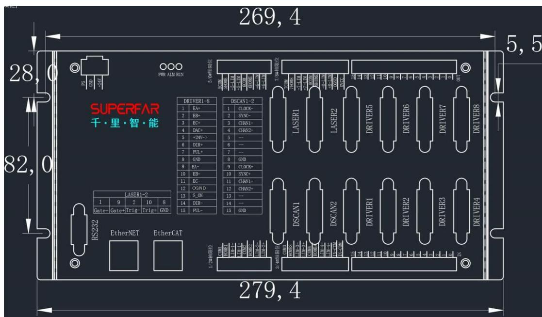
QLS-822 控制卡是千里智能自主研发的高端平台振镜联动卡,采用强大的 CPU 计算,主要用于有多轴运动的平台、振镜、激光的加工应用中,实现平台振镜联动,大大提高加工效率,如 3D 打印,PCB/FPC,指纹识别芯片,摄像头模组等激光精密切割,大幅 PCB 打标,晶圆打标等。
