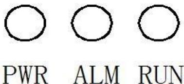
PWR: 24V 供电状态，绿灯常亮则供电正常，不亮请检查 24V 电源信号
