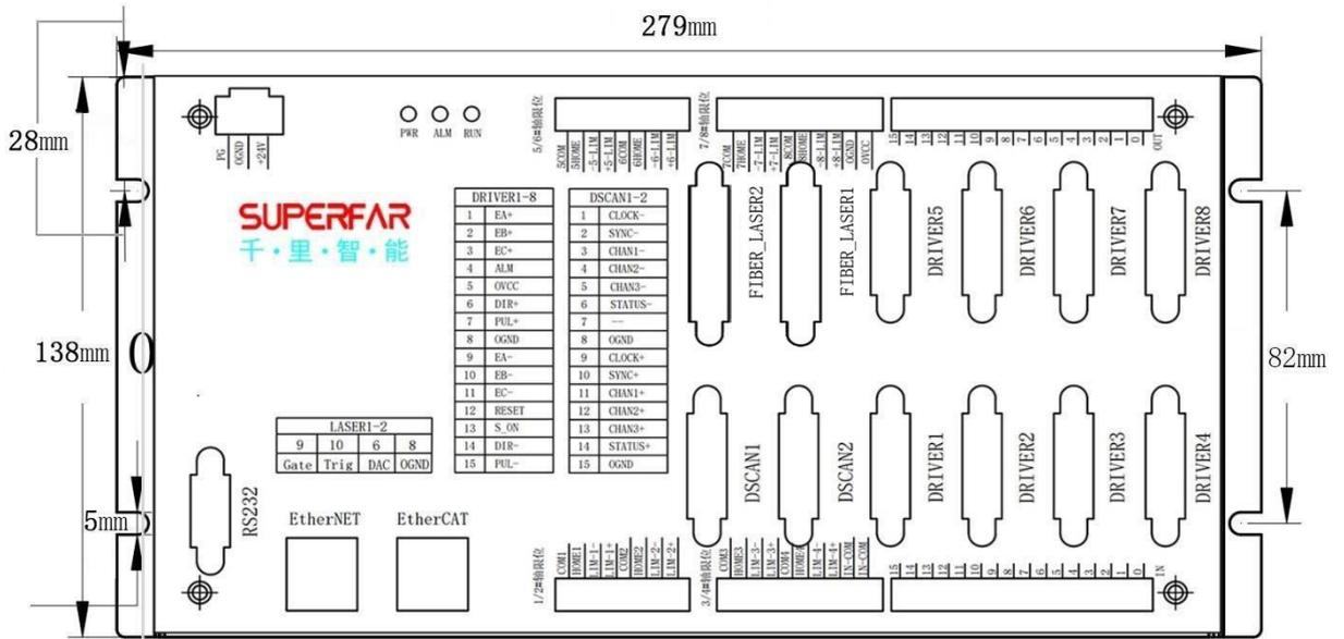
QLS-822 控制卡是千里智能自主研发的高端平台振镜联动卡,采用强大的 CPU 计算,主要用于有多轴运动的平台、振镜、激光的加工应用中,实现平台振镜联动,大大提高加工效率,如 3D 打印, PCB/FPC,指纹识别芯片,摄像头模组等激光精密切割,大幅 PCB 打标,晶圆打标等。
