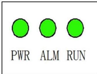
**PWR**: 24V 供电状态，绿灯常亮则供电正常，不亮请检查 24V 电源信号
