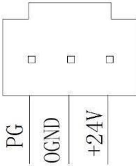
电源 24V 电流不小于 3A，请注意方向和顺序！ **建议：单独使用一个 24V 电源，保证板卡供电与输入输出隔离。**
